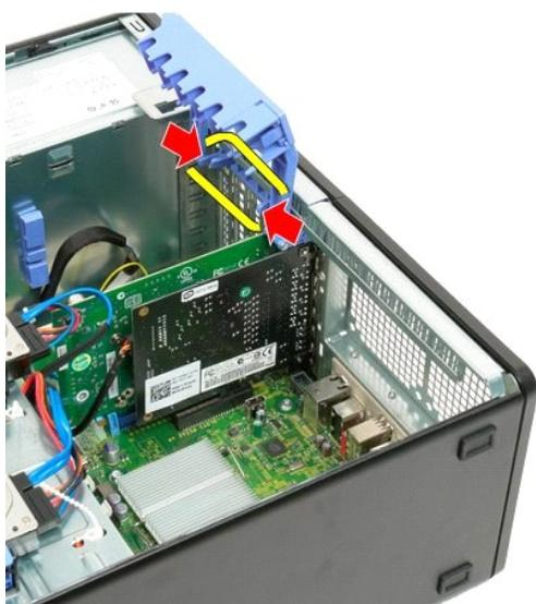
5. Continuare a inclinare il gruppo di contenimento delle schede di espansione verso l'esterno del computer.
