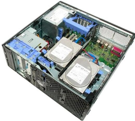
3. Inclinare il braccio di contenimento della scheda di espansione verso il bordo del computer.
