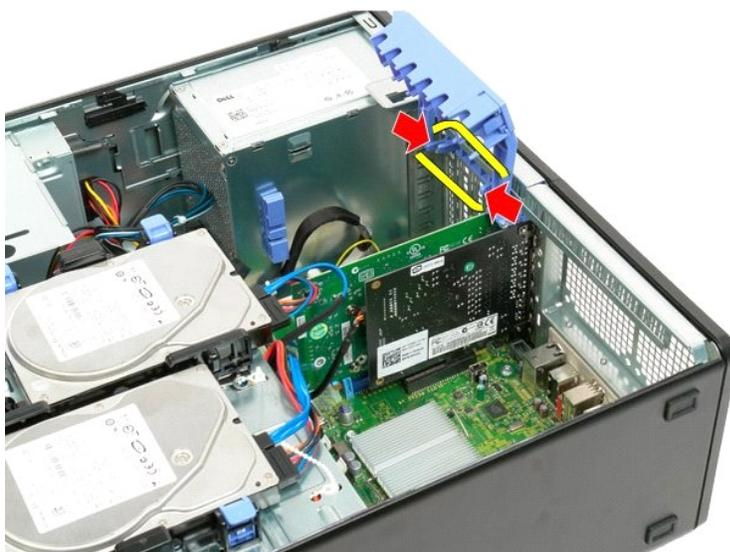
5. Continuare a inclinare il gruppo di contenimento delle schede di espansione verso l'esterno del computer.
