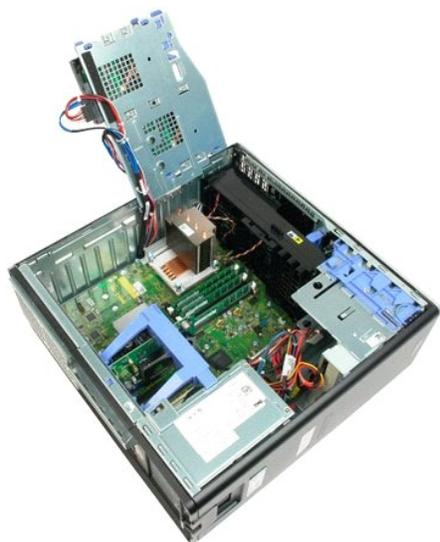
5. Allentare le quattro viti di fissaggio sul dissipatore di calore.
