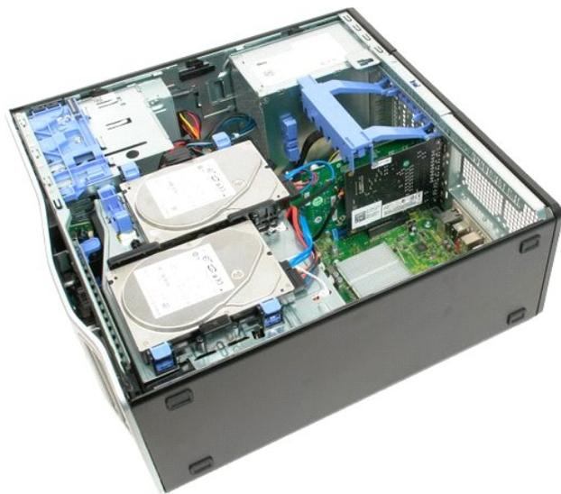
3. Sollevare il braccio del gruppo di contenimento della scheda di espansione e allontanarlo dal telaio.
